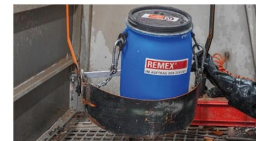
Transport innerhalb der Behandlungsanlage mittels Kran
